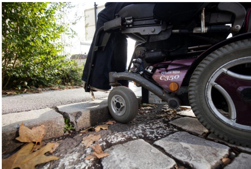
Fotografija 44: Spodnji del električnega invalidskega vozička se nahaja na cestišču pred pločnikom, ki je previsok za kolesa električnega vozička.
