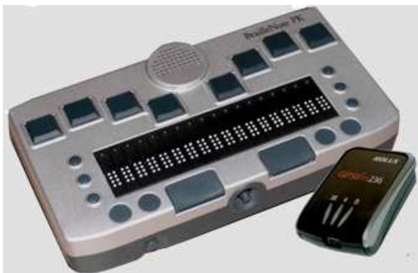
Slika 5: Braille note GPS
